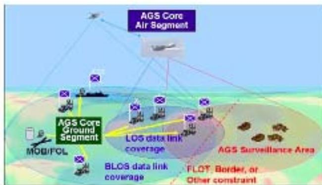
Figura 6 I componenti del sistema AGS
